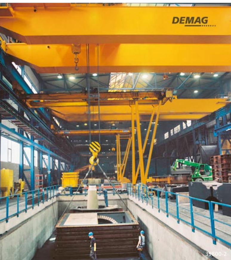
Poziționarea precisă a oalei de turnare și transportul în siguranță la mașina de turnat din turnătorie
