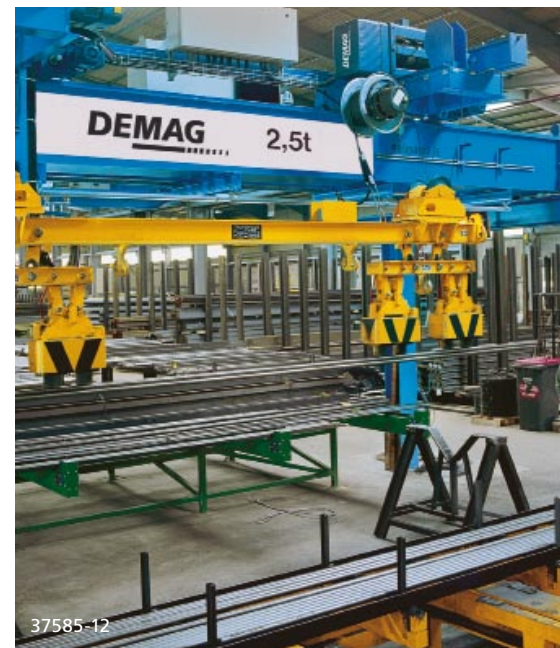
Coilmaster-Demag în depozitele complet automatizate, echipat cu magneți sau graifere folosite ca dispozitive de preluare a sarcinilor
