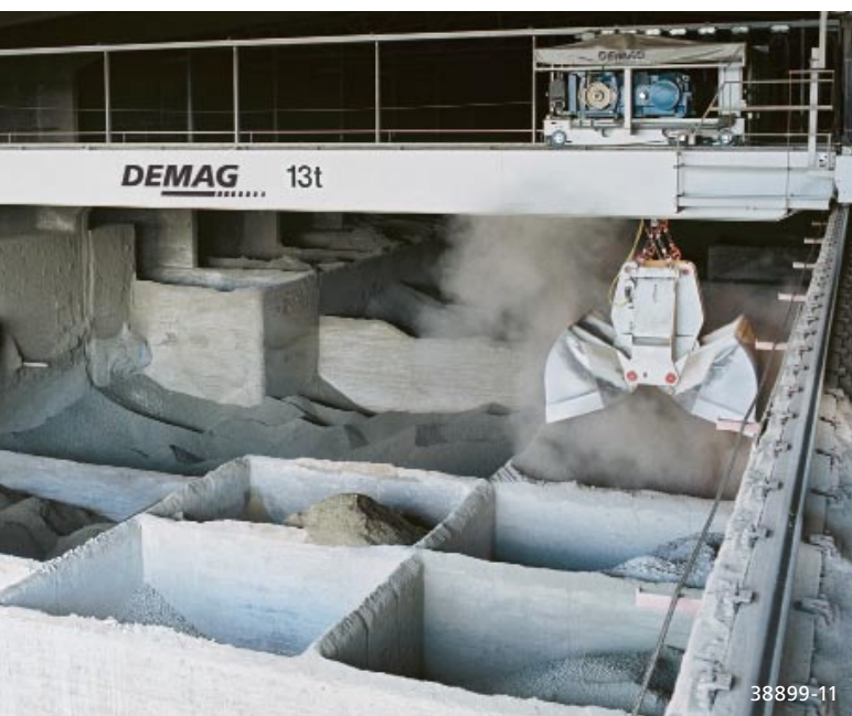
Umplerea complet automată și preluarea diferitelor materii prime cu o macara Demag automatizată, într-o fabrică de ciment
