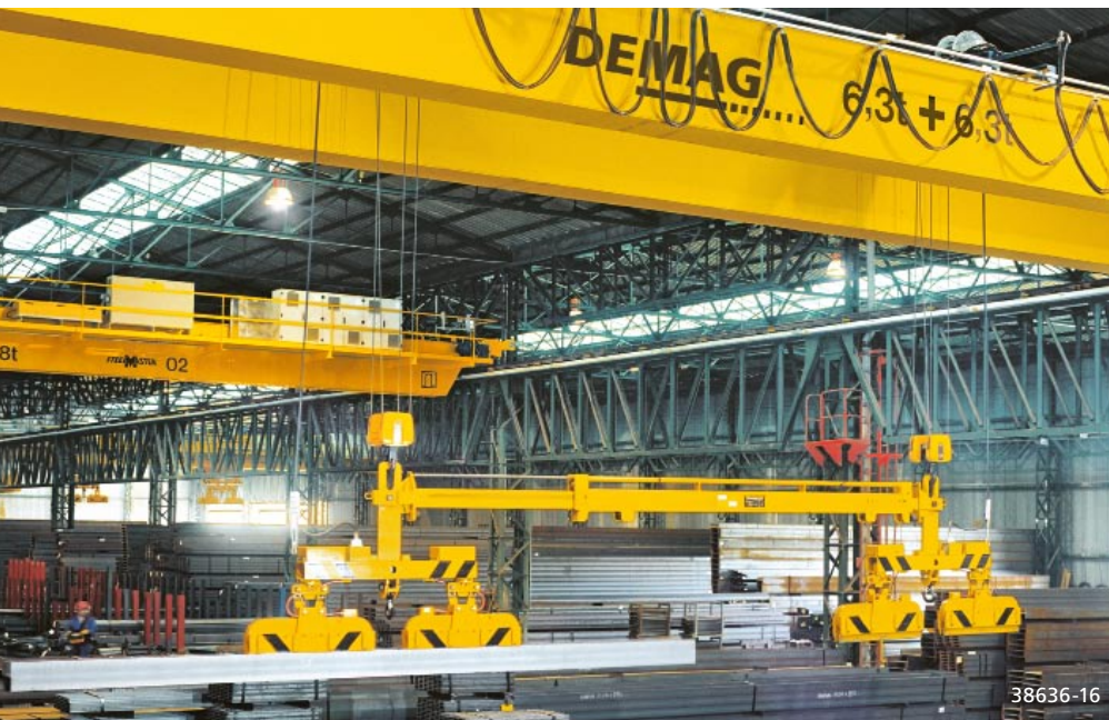
Steelmaster-Demag cu traversă magnetică pentru preluarea produselor lungi, pieselor individuale, respectiv tablelor
