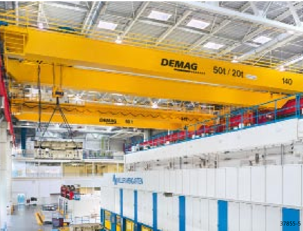
Macarale de proces Demag în atelierul de presare pentru schimbul de scule în industria automobilelor
