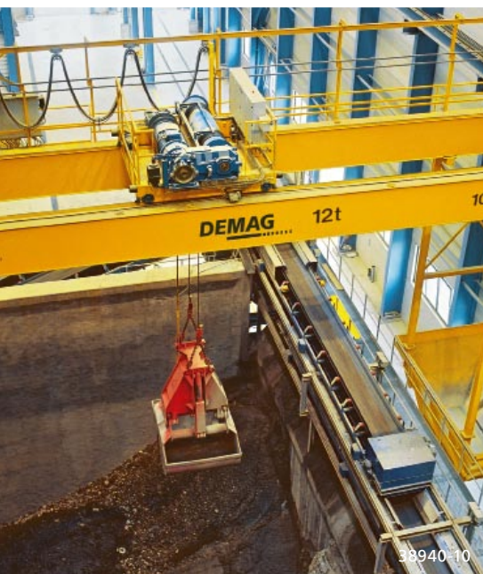
Macarale de proces Demag în timpul procesului de evacuare a deșeurilor
